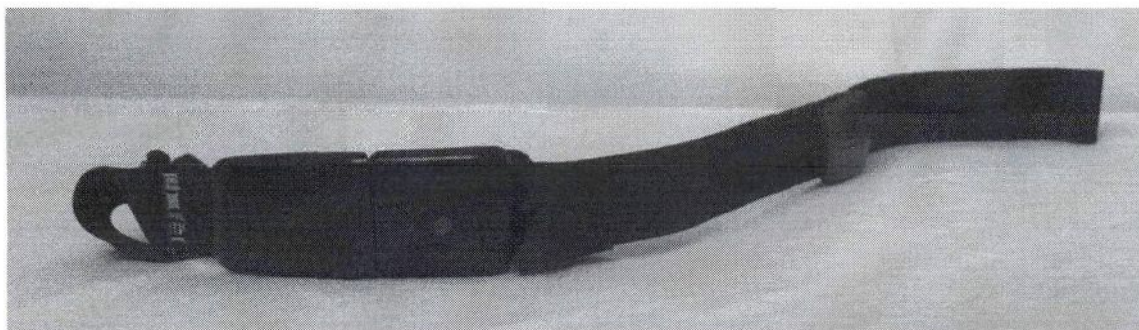
Рис. 3. Вид биопояса со встроенным Биомодулем «БМ», с автономным источником питания и модулем Bluetooth.
